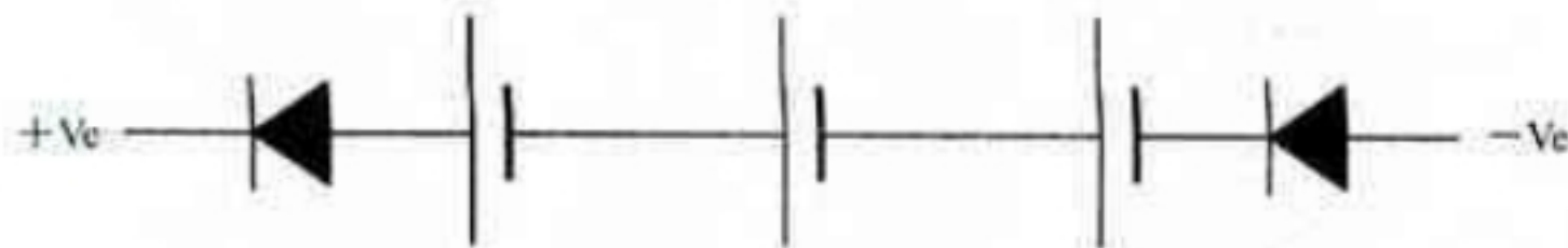
图 E.2 符合 E.4.3 要求的阻塞二极管的安装
